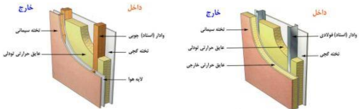
محدود بودن پل حرارتی در ساختمان با سازه چوبی
